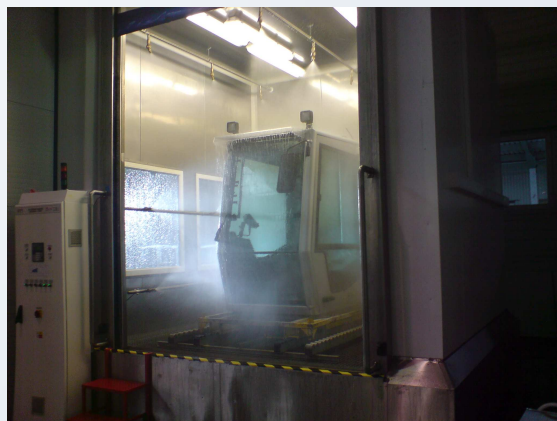
Zkušební stříkací kabina
