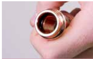
6. Zkontrolujte usazení O-kroužku
