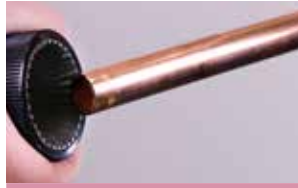
2. Odjehlete a odstraňte všechny vnější ostré hrany
