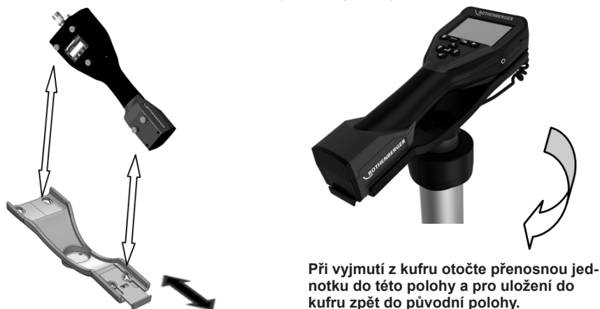
Obrázek 4 - Instalace přenosné jednotky ROSCOPE 1000/i2000 na montážní kolébku
